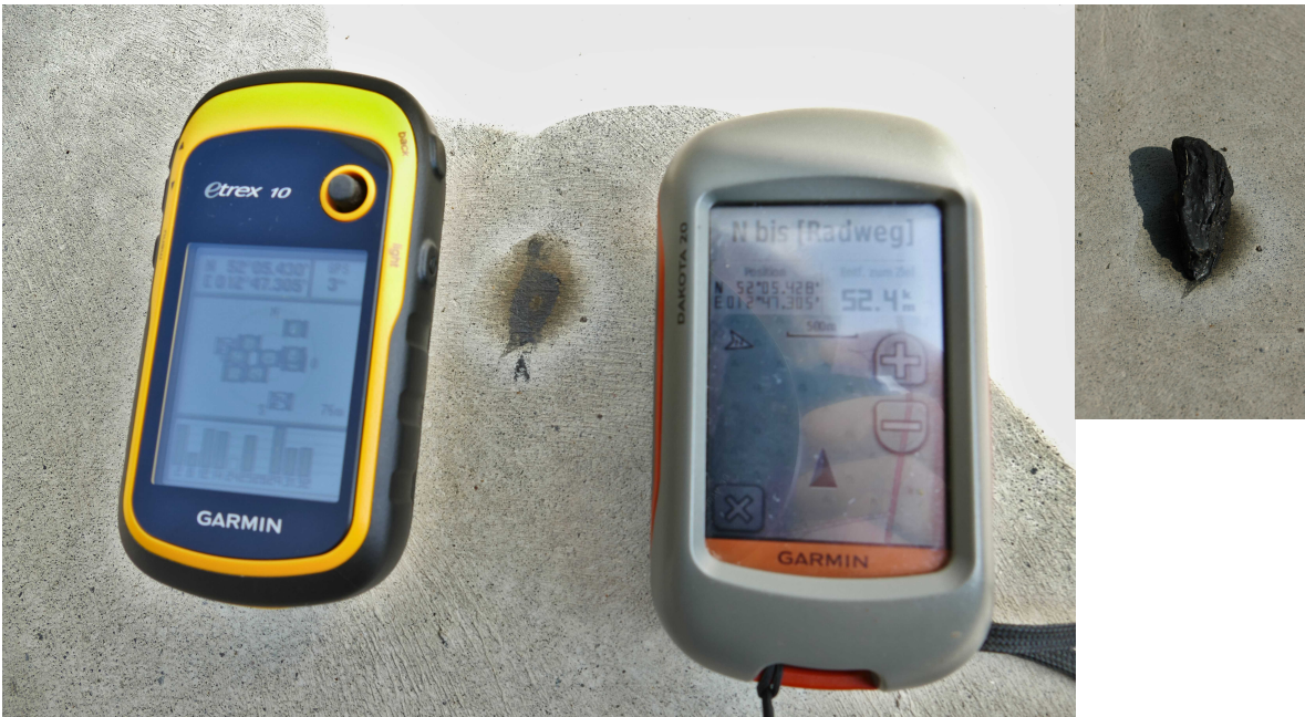
Abbildung 10: Schmierfettfund (rot markiert) an der Windkraftanlage GE-28130155; Aufnahme mit GPS-Koordinaten-Abgleich, Schmierfett wurde vor der GPS-Dokumentation von Monitorer entfernt und daher anschließend der verbleibende Abdruck aufgenommen. Das Schmierfett ist oben rechts einzeln abgebildet.
