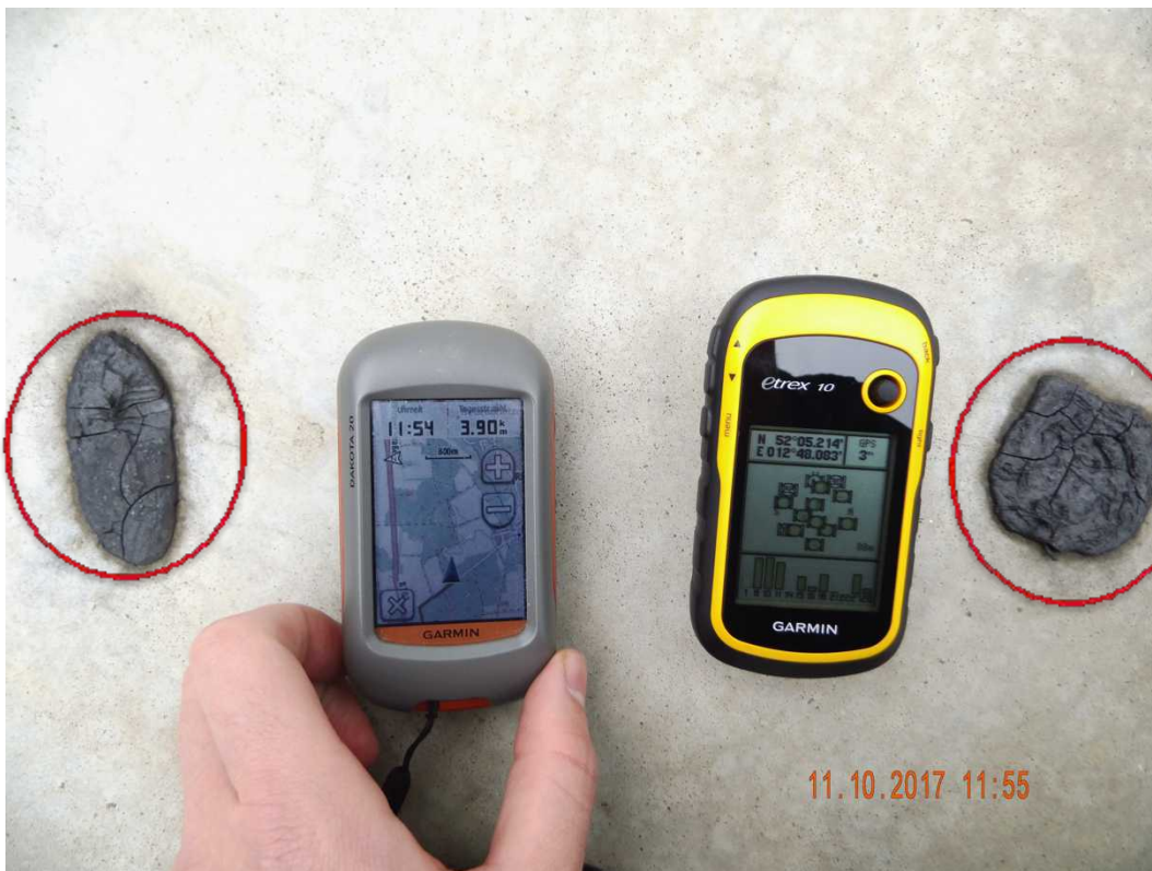
Abbildung 42: Schmierfettfunde (rot markiert) an der Windkraftanlage GE-28130158; Aufnahme mit Kartenaufnahme und GPS-Koordinaten
