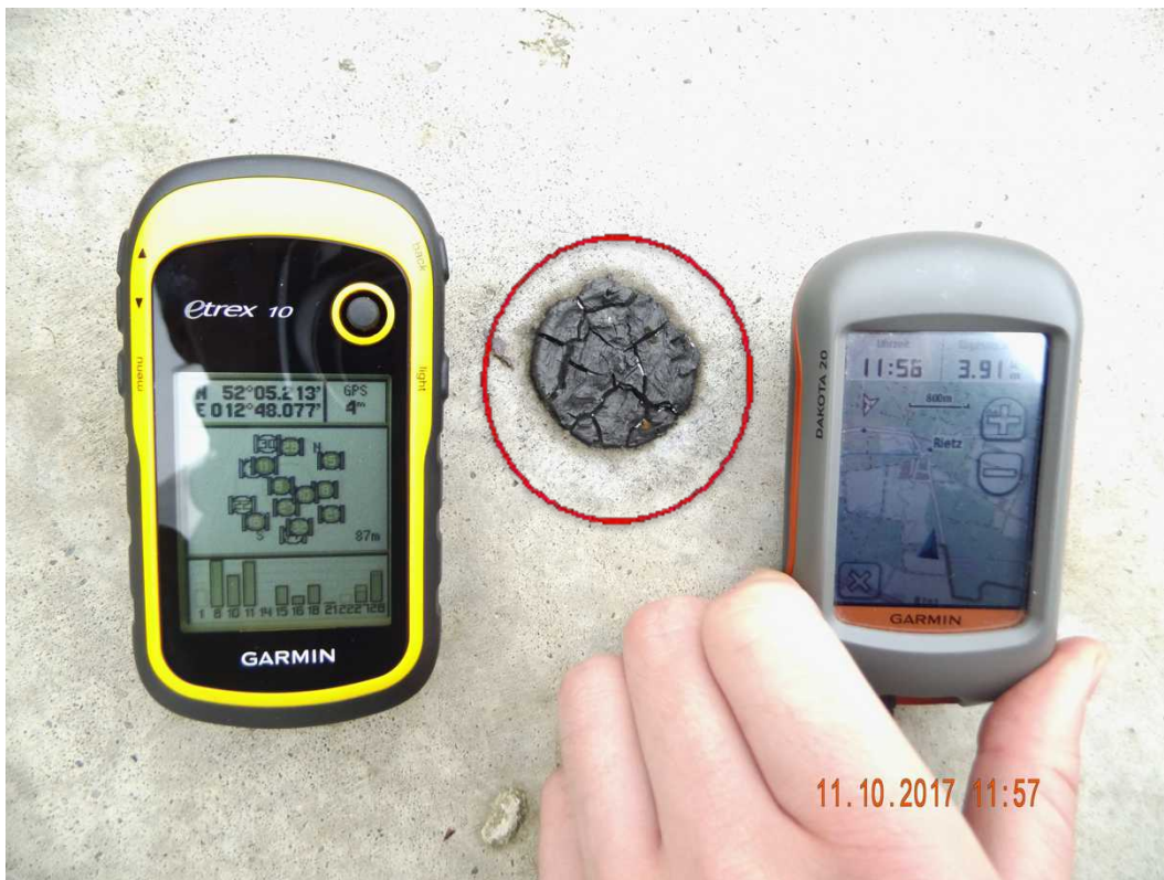
Abbildung 48: Schmierfettfund (rot markiert) an der Windkraftanlage GE-28130158; Aufnahme mit Kartenaufnahme und GPS-Koordinaten
