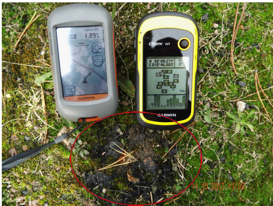
Abbildung 30: Schmierfettfund (rot markiert) an der Windkraftanlage GE-28130157; Aufnahme mit Kartenaufnahme und GPS-Koordinaten
