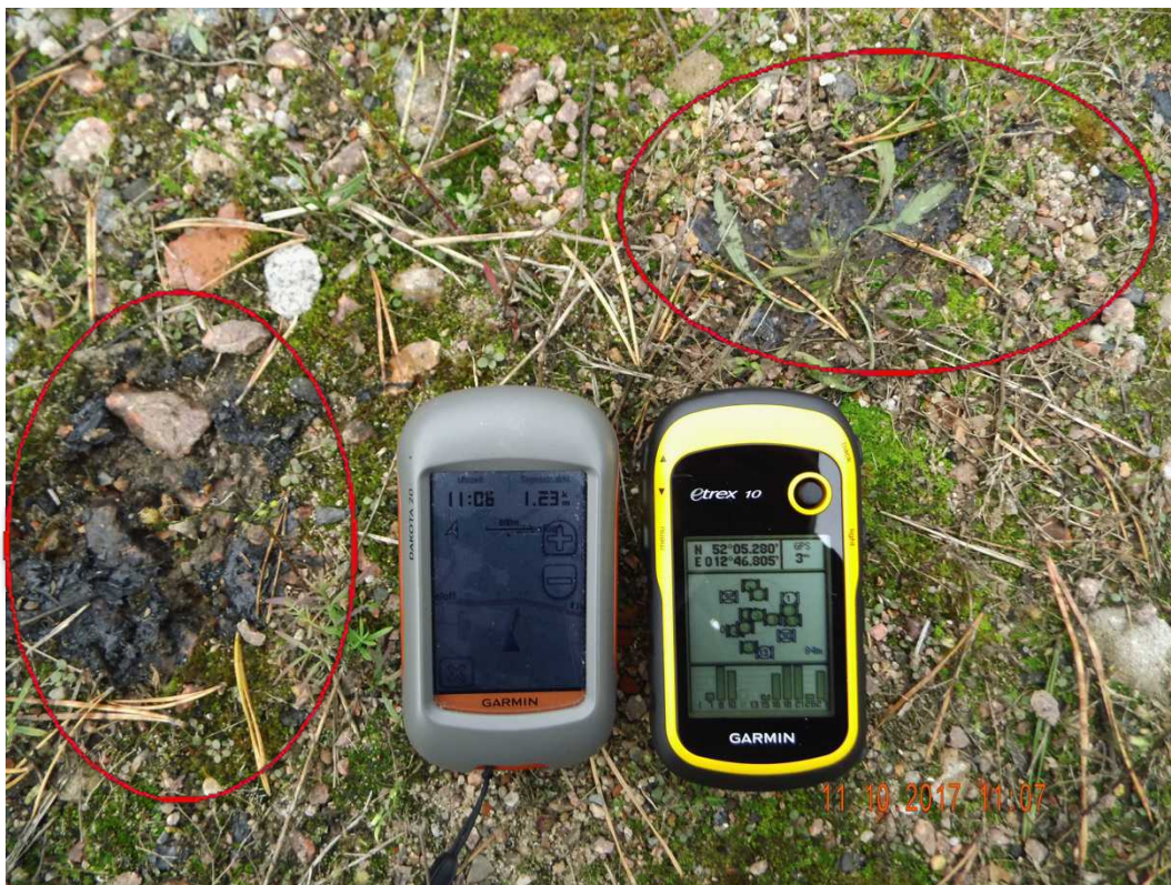
Abbildung 28: Schmierfettfund (rot markiert) an der Windkraftanlage GE-28130157; Aufnahme mit Kartenaufnahme und GPS-Koordinaten
