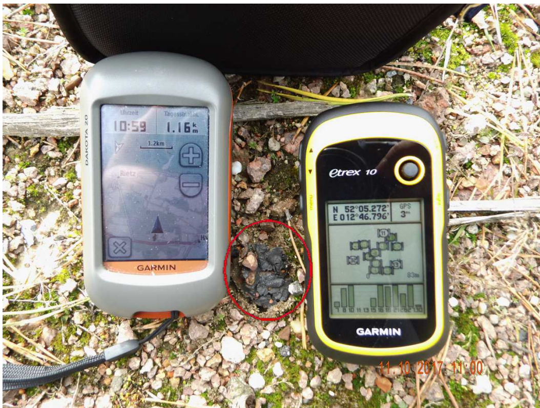
Abbildung 24: Schmierfettfund (rot markiert) an der Windkraftanlage GE-28130157; Aufnahme mit Kartenaufnahme und GPS-Koordinaten
