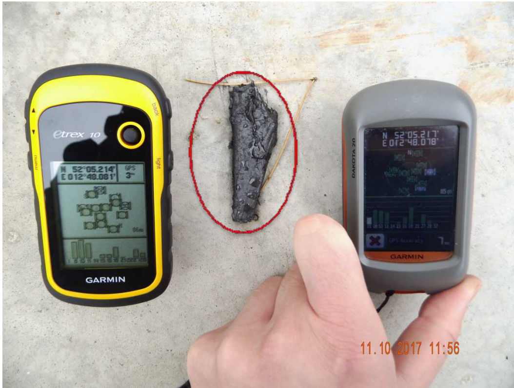
Abbildung 47: Schmierfettfund (rot markiert) an der Windkraftanlage GE-28130158; Aufnahme mit GPS-Koordinaten-Abgleich
