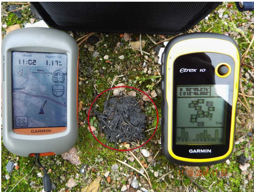
Abbildung 26: Schmierfettfund (rot markiert) an der Windkraftanlage GE-28130157; Aufnahme mit Kartenaufnahme und GPS-Koordinaten
