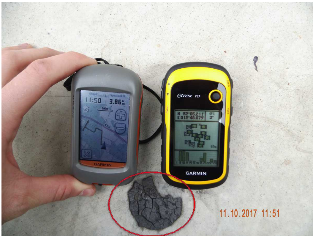
Abbildung 34: Schmierfettfund (rot markiert) an der Windkraftanlage GE-28130158; Aufnahme mit Kartenaufnahme und GPS-Koordinaten
