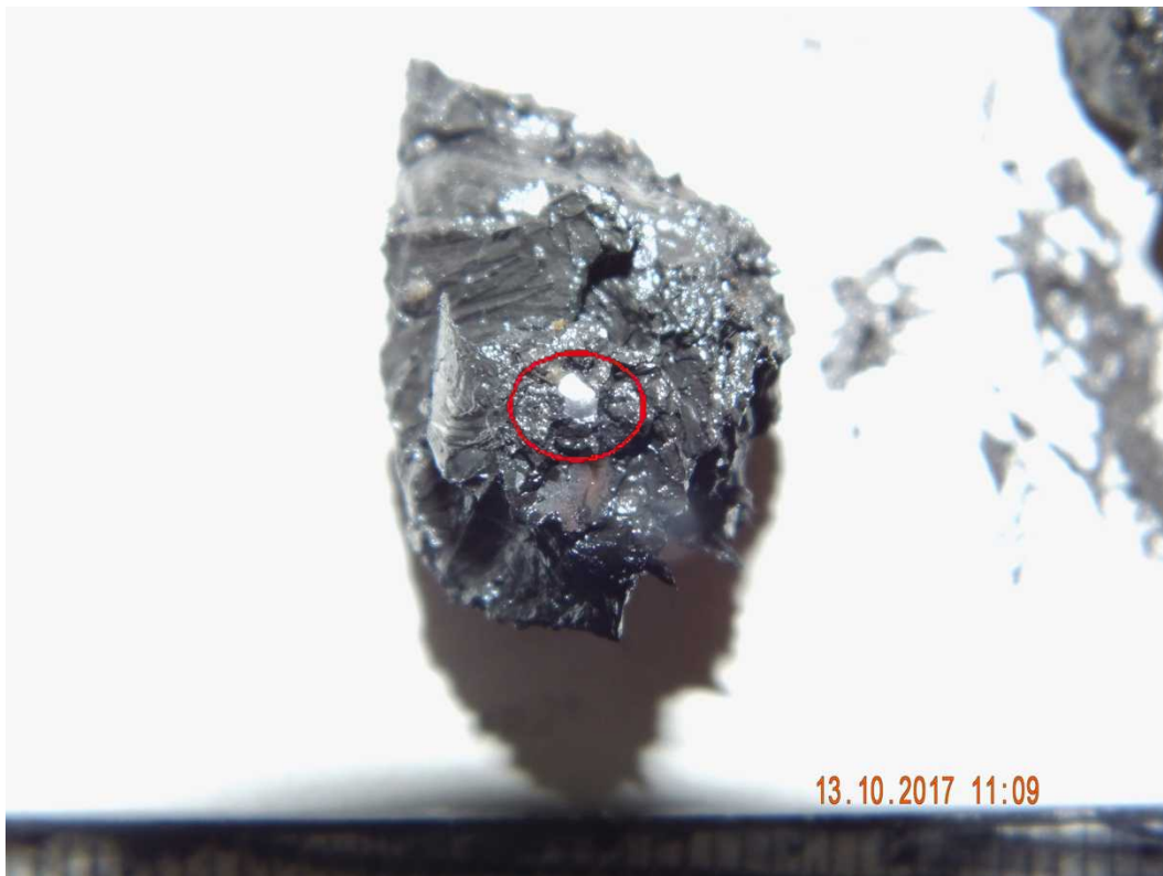
Abbildung 58: Schmierfettprobe von der Anlage GE-28130158 vom 23.09.2017 mit metallischen Stücken (rot markiert).
