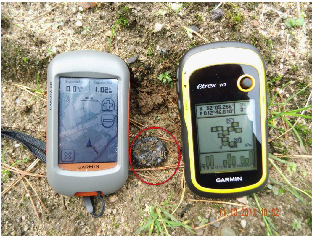
Abbildung 22: Schmierfettfund (rot markiert) an der Windkraftanlage GE-28130157; Aufnahme mit Kartenaufnahme und GPS-Koordinaten
