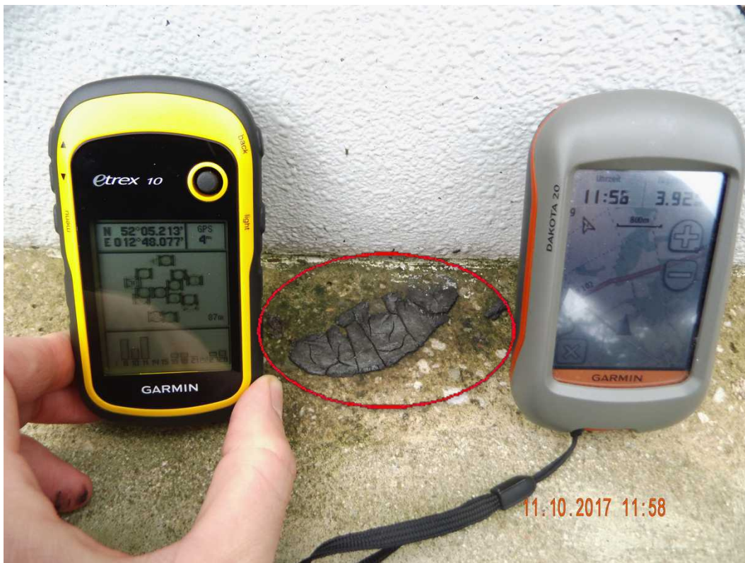
Abbildung 50: Schmierfettfund (rot markiert) an der Windkraftanlage GE-28130158; Aufnahme mit Kartenaufnahme und GPS-Koordinaten
