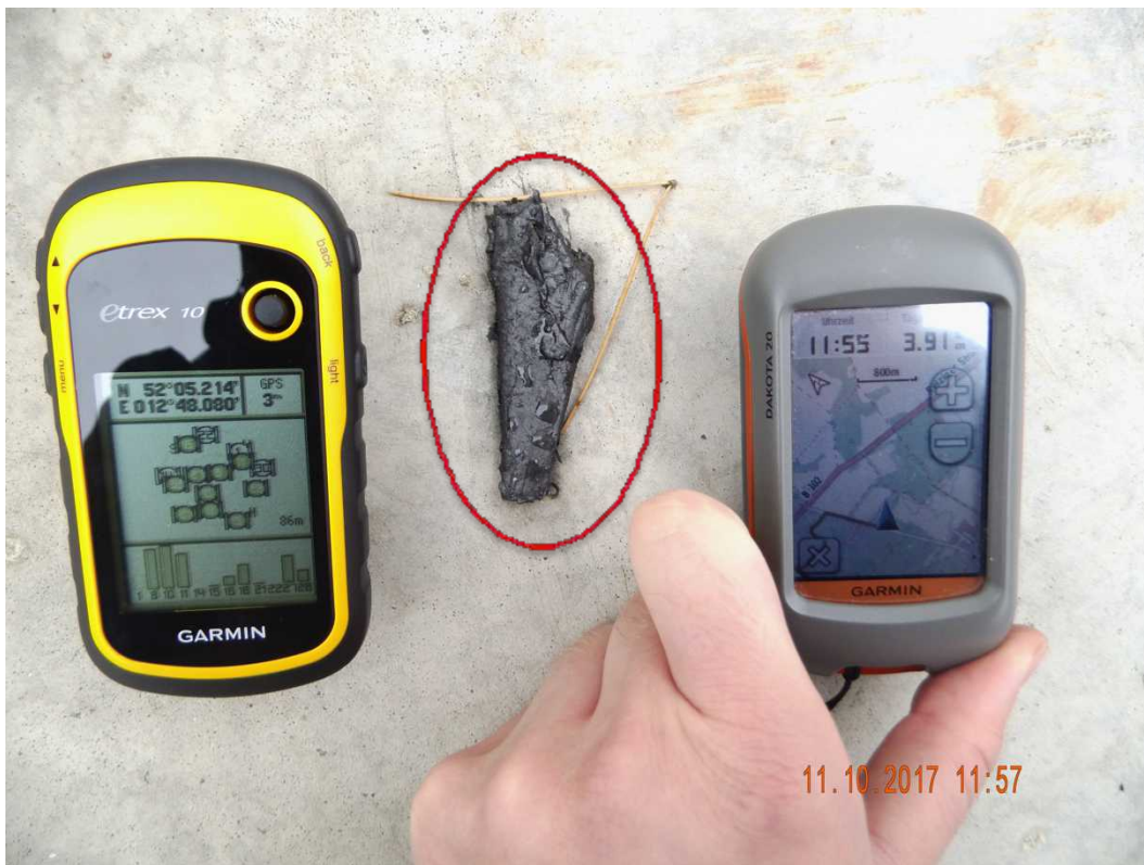
Abbildung 46: Schmierfettfund (rot markiert) an der Windkraftanlage GE-28130158; Aufnahme mit Kartenaufnahme und GPS-Koordinaten
