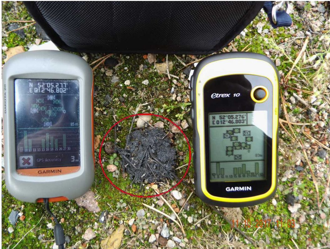
Abbildung 27: Schmierfettfund (rot markiert) an der Windkraftanlage GE-28130157; Aufnahme mit GPS-Koordinaten-Abgleich
