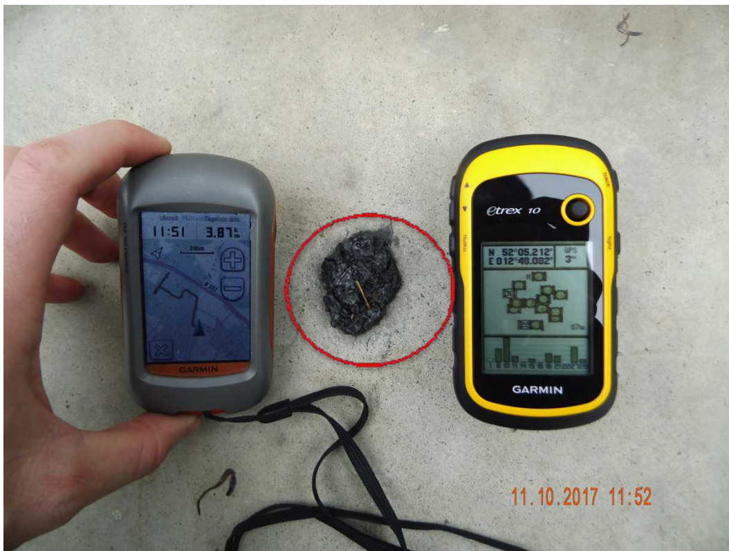
Abbildung 36: Schmierfettfund (rot markiert) an der Windkraftanlage GE-28130158; Aufnahme mit Kartenaufnahme und GPS-Koordinaten
