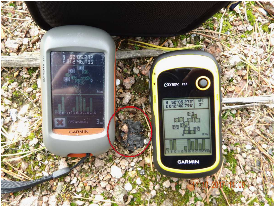
Abbildung 25: Schmierfettfund (rot markiert) an der Windkraftanlage GE-28130157; Aufnahme mit GPS-Koordinaten-Abgleich
