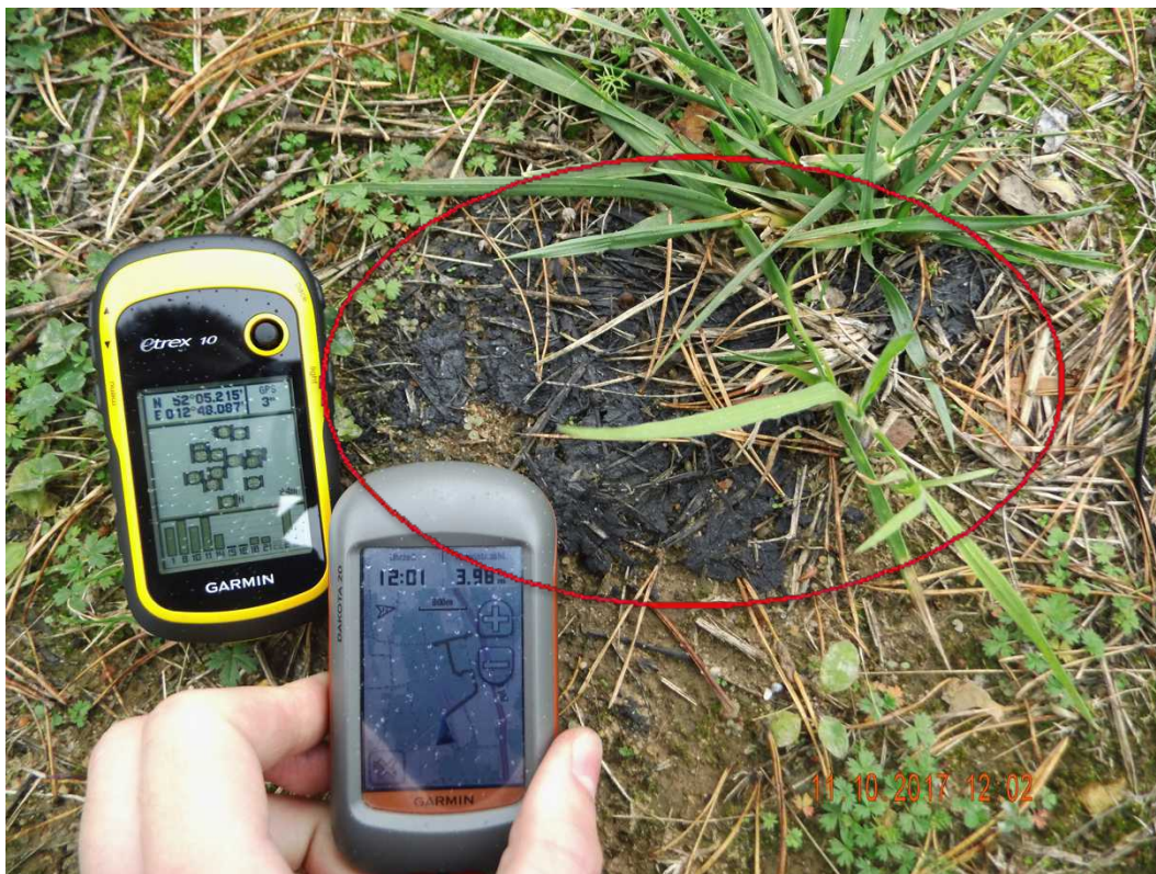
Abbildung 52: Schmierfettfund (rot markiert) an der Windkraftanlage GE-28130158; Aufnahme mit Kartenaufnahme und GPS-Koordinaten
