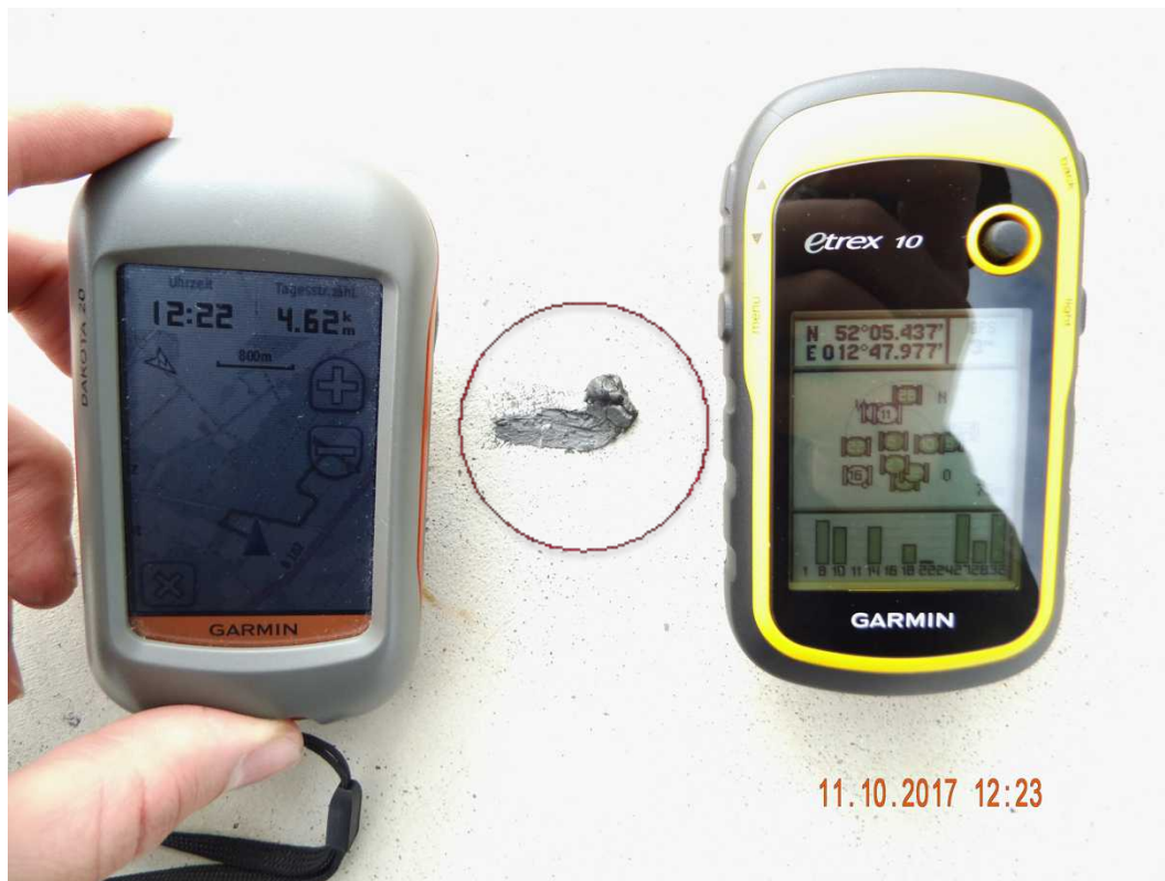
Abbildung 13: Schmierfettfund (rot markiert) an der Windkraftanlage GE-28130156; Aufnahme mit Kartenaufnahme und GPS-Koordinaten
