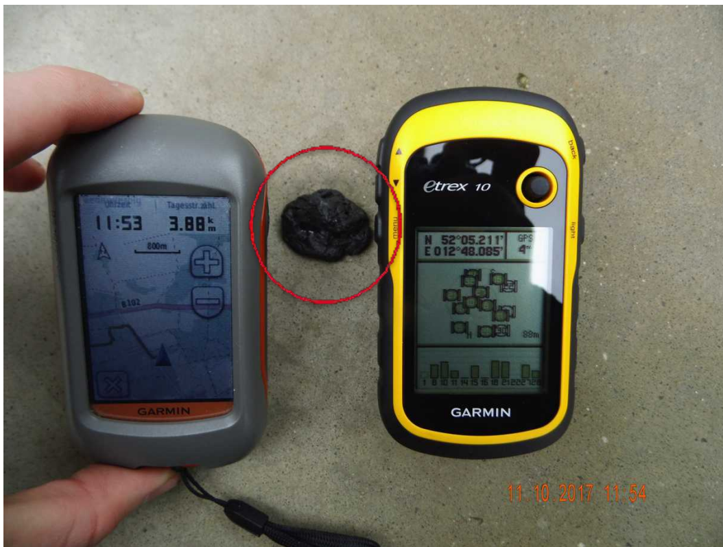
Abbildung 40: Schmierfettfund (rot markiert) an der Windkraftanlage GE-28130158; Aufnahme mit Kartenaufnahme und GPS-Koordinaten
