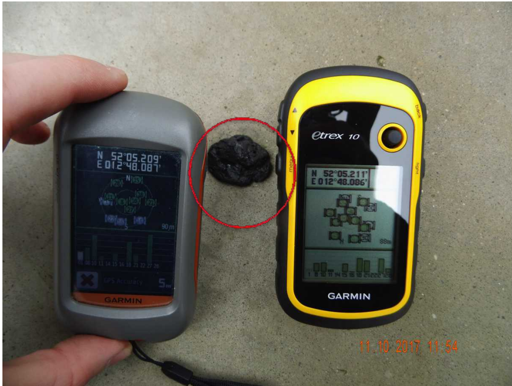
Abbildung 41: Schmierfettfund (rot markiert) an der Windkraftanlage GE-28130158; Aufnahme mit GPS-Koordinaten-Abgleich
