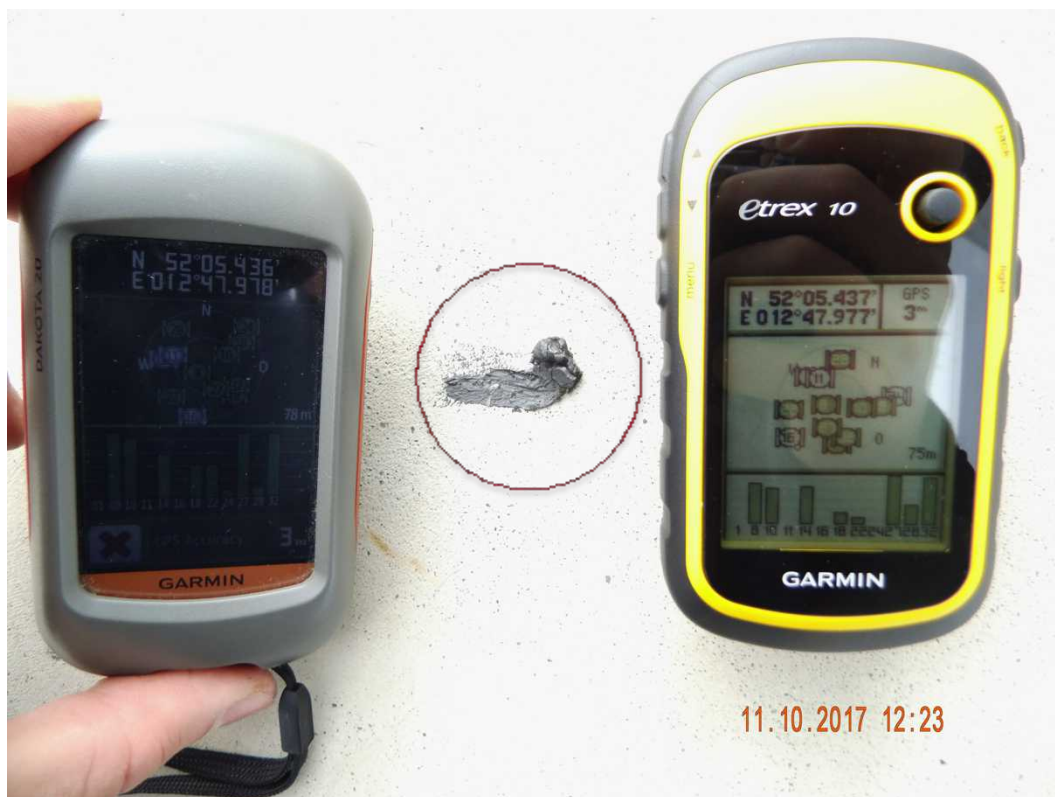
Abbildung 14: Schmierfettfund (rot markiert) an der Windkraftanlage GE-28130156; Aufnahme mit GPS-Koordinaten-Abgleich
