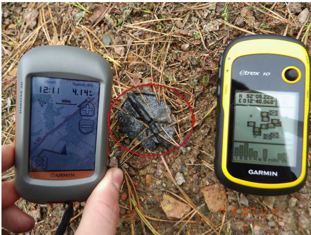
Abbildung 56: Schmierfettfund (rot markiert) an der Windkraftanlage GE-28130158; Aufnahme mit Kartenaufnahme und GPS-Koordinaten
