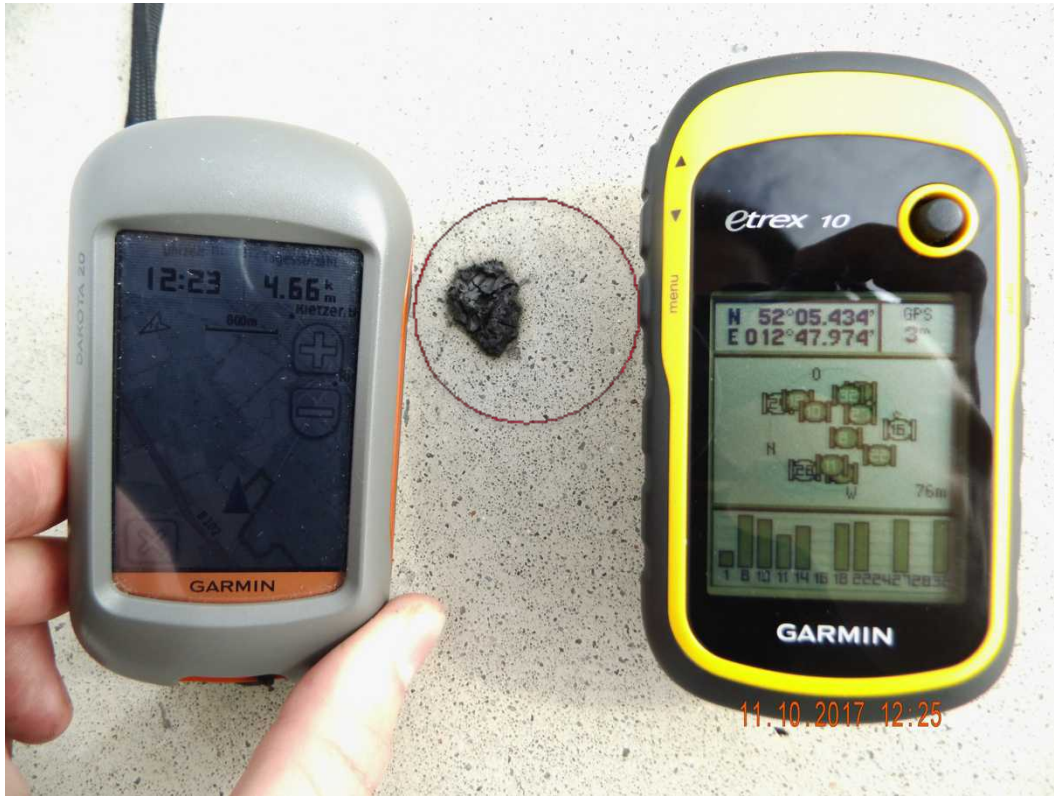
Abbildung 15: Schmierfettfund (rot markiert) an der Windkraftanlage GE-28130156; Aufnahme mit Kartenaufnahme und GPS-Koordinaten
