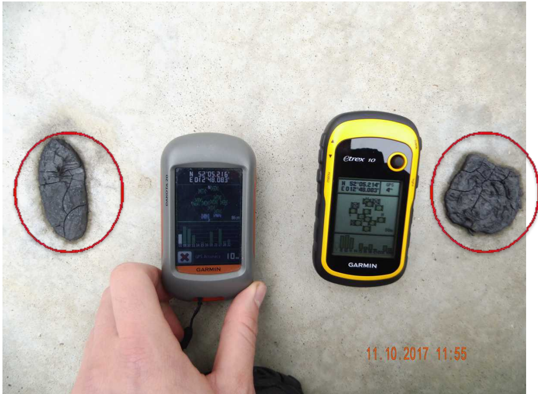
Abbildung 43: Schmierfettfunde (rot markiert) an der Windkraftanlage GE-28130158; Aufnahme mit GPS-Koordinaten-Abgleich
