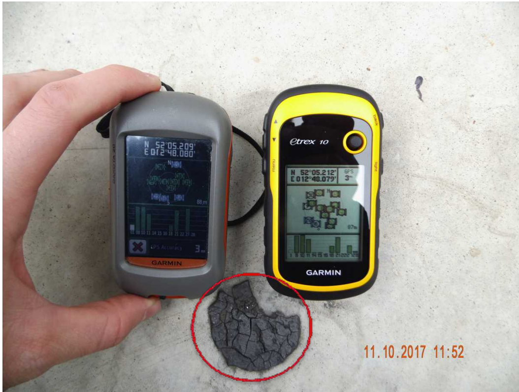
Abbildung 35: Schmierfettfund (rot markiert) an der Windkraftanlage GE-28130158; Aufnahme mit GPS-Koordinaten-Abgleich
