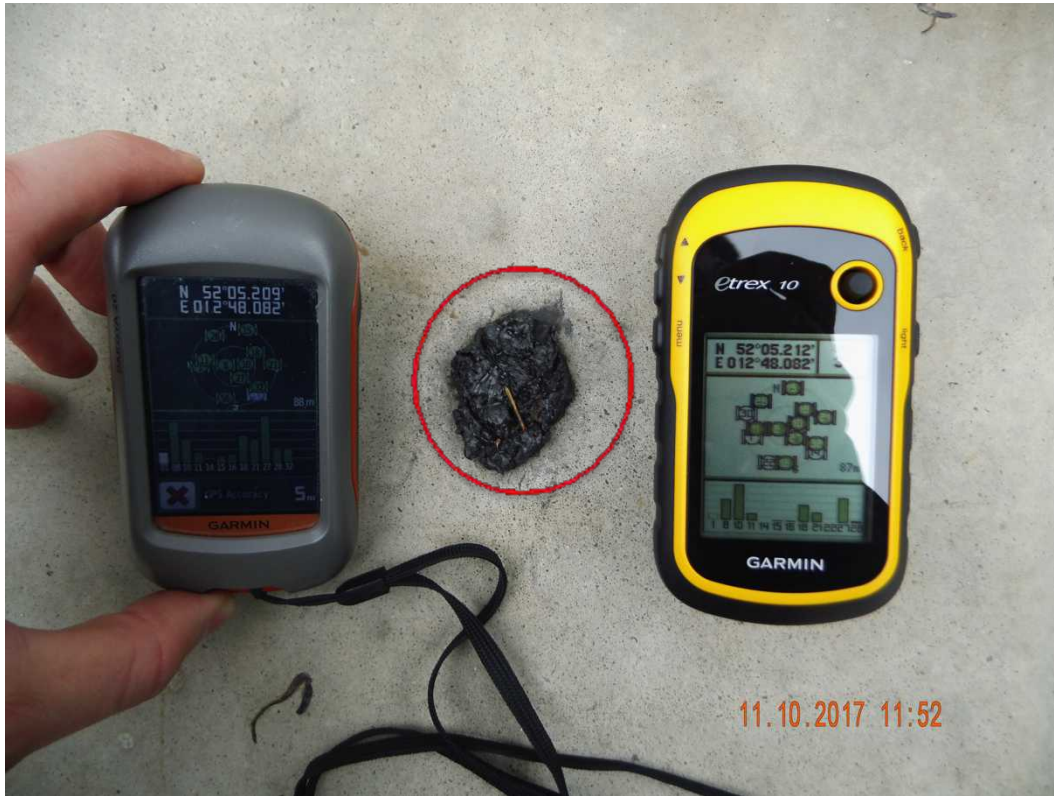
Abbildung 37: Schmierfettfund (rot markiert) an der Windkraftanlage GE-28130158; Aufnahme mit GPS-Koordinaten-Abgleich
