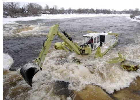
Eisaufbruch in Nordamerika mit Amphibex-Schwimmbagger (Normrock Industries Inc.)
